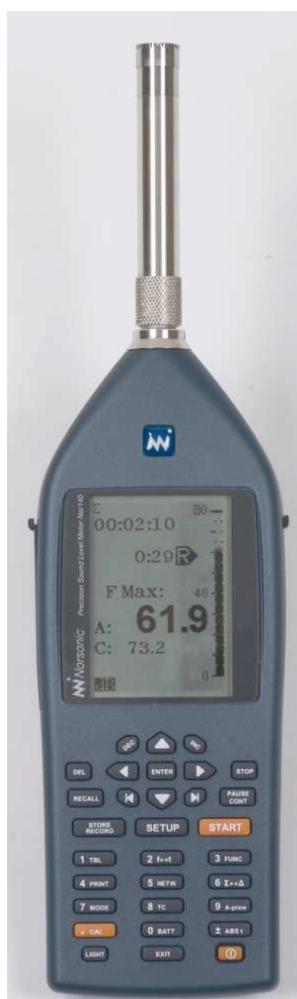
Le sonomètre type NOR140 comporte un clavier et un écran LCD monochrome.
